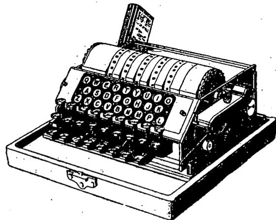
FIG. 10.—ELECTRICAL CIPHER MACHINE EMPLOYING A TYPEWRITER KEYBOARD
